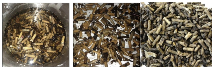
Obrázok 8: (a) Zapuzdrenie CB parafínom, (b) sušenie CB v jednej vrstve, (c) ochladené a vytvrdené zapuzdrené CB
